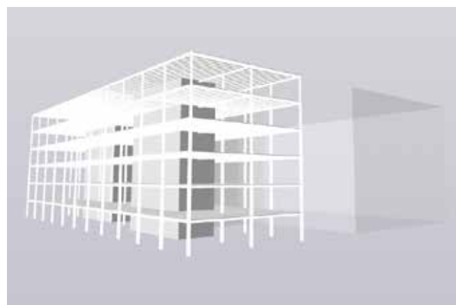
Bild 8 Visualisierung der finalen Tragwerksvariante mit HBV-Decken
