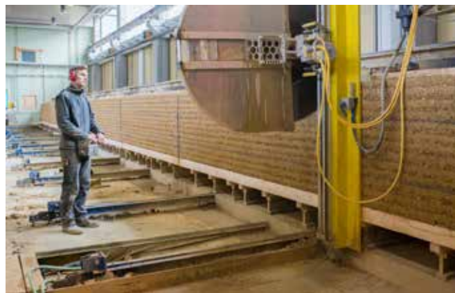
Bild 4 Produktion einer Stampflehmfassade, hier: Zuschneiden von Blöcken vor dem Versetzen für den Alnatura Campus Darmstadt
