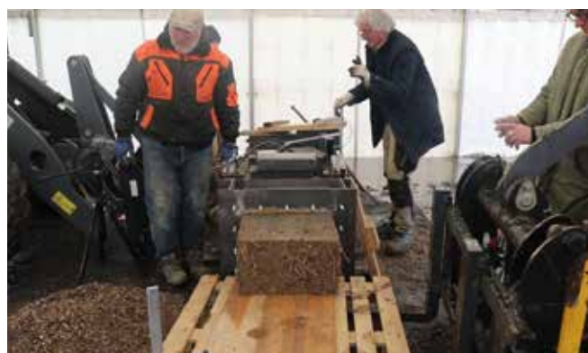
Bild 7 Pilotversuch im März 2021: im Maßstab 1:4 hydraulisch gepresster Block aus Recycling-Wellerlehm Masse eines thüringischen Gebäudes von 1711
