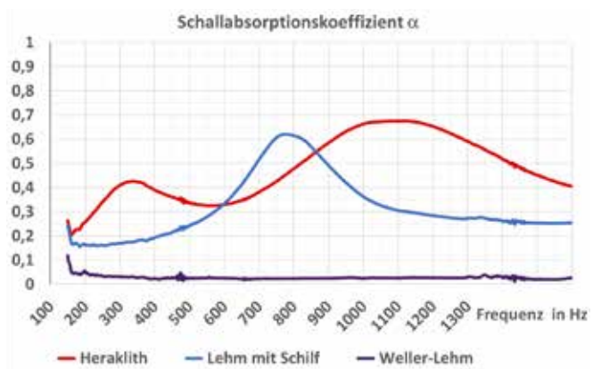
Bild 17 Diagramm Schallabsorptionsmessung Proben Wellerlehmoberfläche (violett), Lehm mit senkrecht zur Oberfläche integrierenden Schilfhalmern (blau), Stampflehm mit integriertem Heraklith
