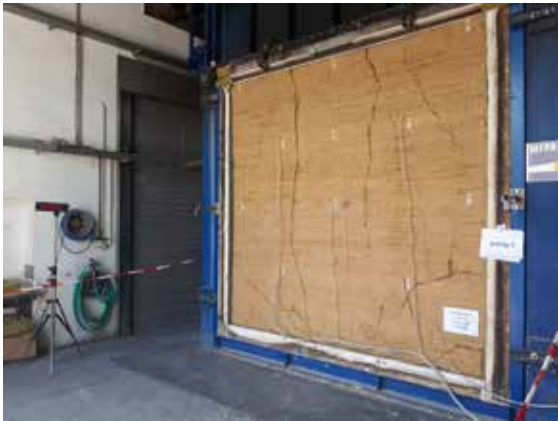
Bild 16 Brandversuch Lehmwand an der MFPA Leipzig GmbH aus Forschungsprojekt Ecosights (gefördert durch DBU Deutsche Bundesstiftung Umwelt, AZ 35442/02-25) zum Museumsneubau im LWL-Freilichtmuseum Detmold
