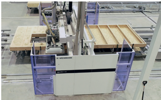
Bild 1 Hochgradig automatisierte Vorfertigung der Elemente
