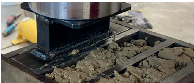
Pressvorrichtung, Füllen und Verdichten
