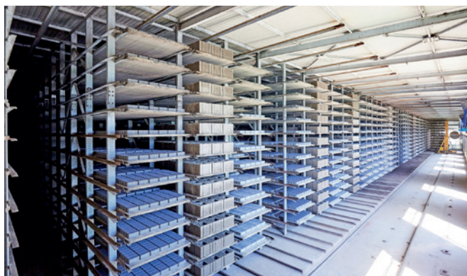
Bild 3 Klimafreundliche Produktion: KLB Leichtbetonsteine müssen keinen Brennprozess durchlaufen; stattdessen werden sie in Stahlformen verfüllt, verdichtet und im Hochregallager getrocknet
