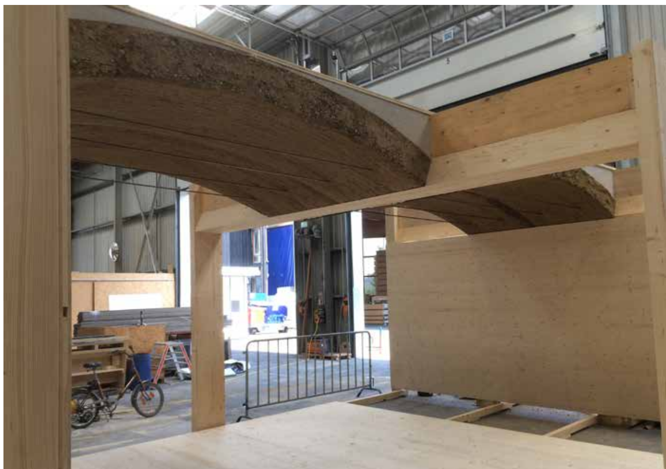
Bild 1 Mock-up der tragenden Lehm Bögen
