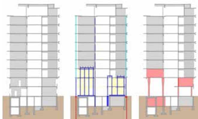
Umbaukonzept Foyer: Bestand/Notsprießung und Abbruch/Neubau
