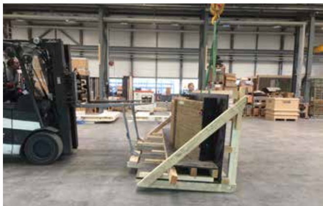
Bild 8 Drehen eines Bogenelements mit dem Kipptisch
