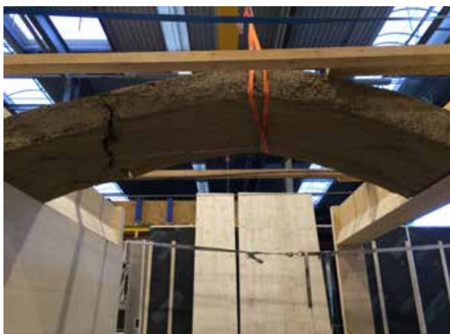
Bild 17 Rückbau durch Anheben der Bögen
